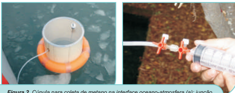
Figura 2. Cúpula para coleta de metano na interface oceano-atmosfera (a); junção da cânula de saída da cúpula com a seringa utilizada para a amostragem do gás (b).
